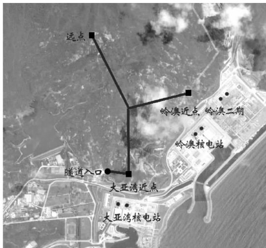
大亚湾反应堆中微子实验的布局示意图
